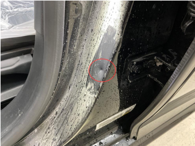
1.2 Bulk(er) med lakkskade
