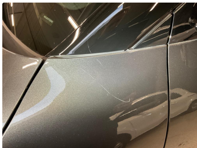
1.3 Ripe(r) ned til grunning - samt A-stolpe
