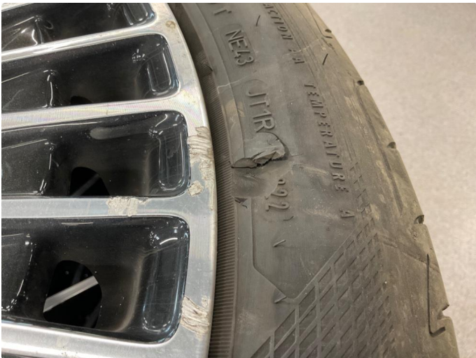
1.2 1 stk. kant kjørt sommerfelg, samt skadet dekk
