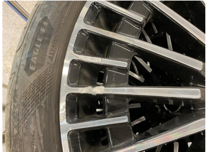
1.2 1 stk. kant kjørt sommerfelg, samt skadet dekk
