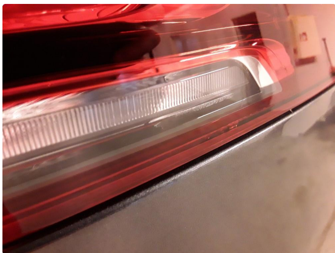
3.1 Krakelering i plast
