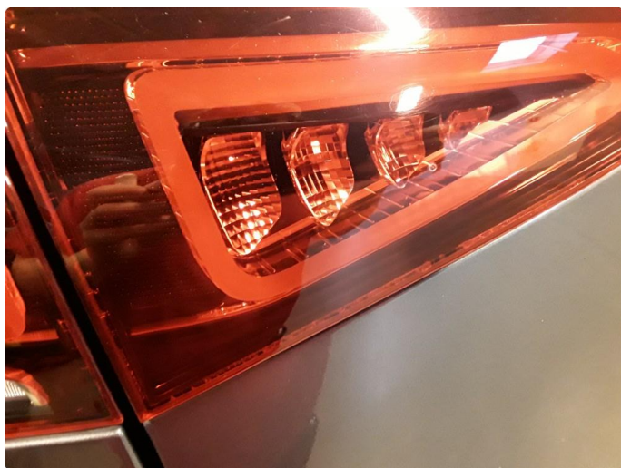
3.1 Krakelering i plast
