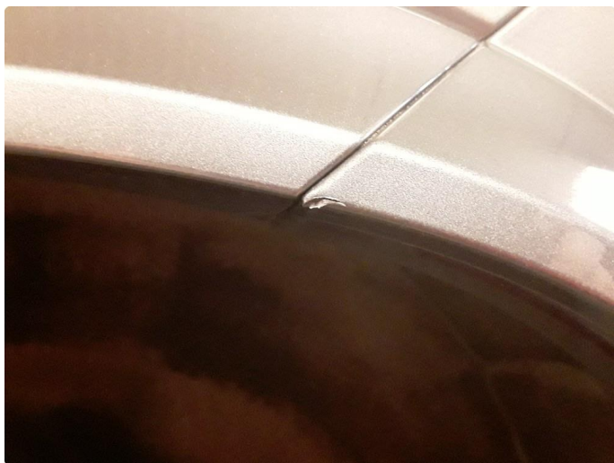
2.4 Ripe(r) ned til grunning /hakk
