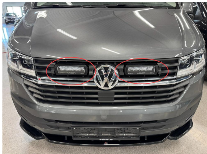
2.1 Det er ettermontert LEDlys i grillen som er koblet til bilens lyssystem (kvittering ligger vedlagt)
