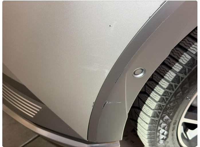
1.3 Ripe(r) ned til grunning
