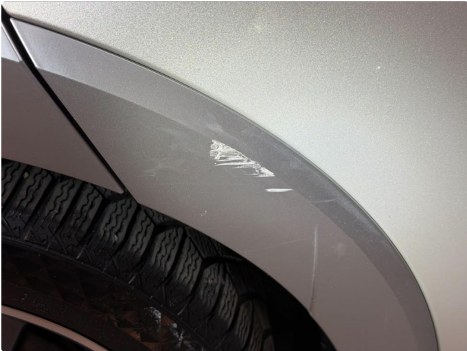
1.1 Ripe ned til grunning
