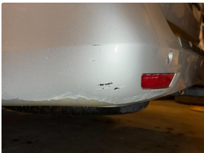
1.3 Ripe(r) ned til grunning
