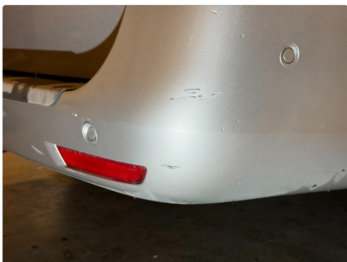
1.3 Ripe(r) ned til grunning
