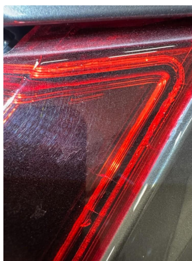
2.1 Defekt / sprukket glass
