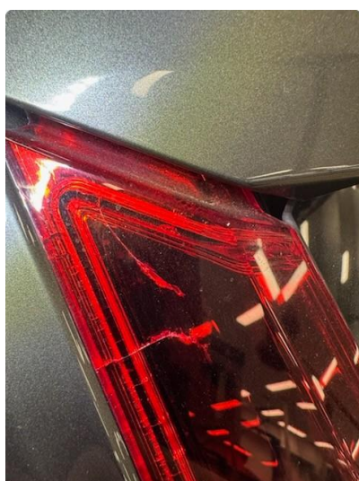
2.1 Defekt / sprukket glass
