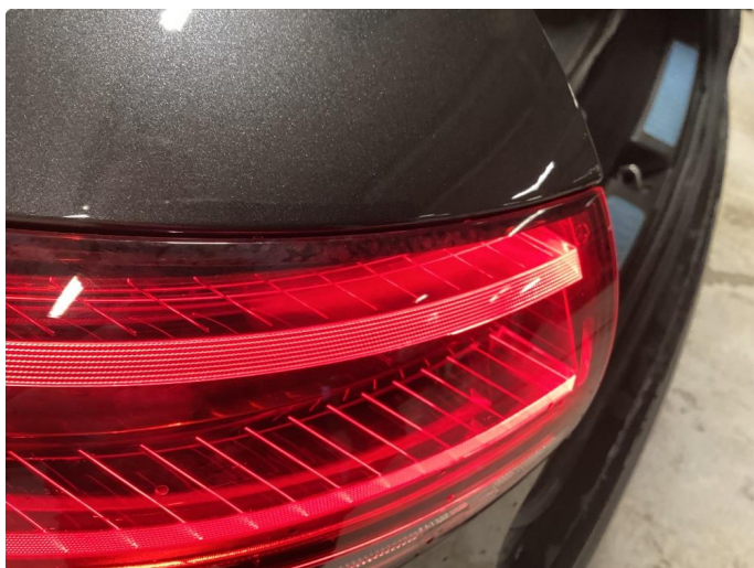
2.1 Belegg på innsiden av begge baklykter.
