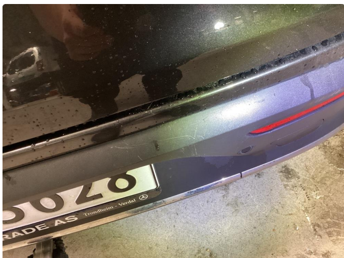
1.4 Noen riper på støtfanger vsb. er også noen riper rett under innsteg til bakluke.
