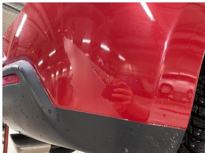
1.1 Noen små bulker med lakkskader
