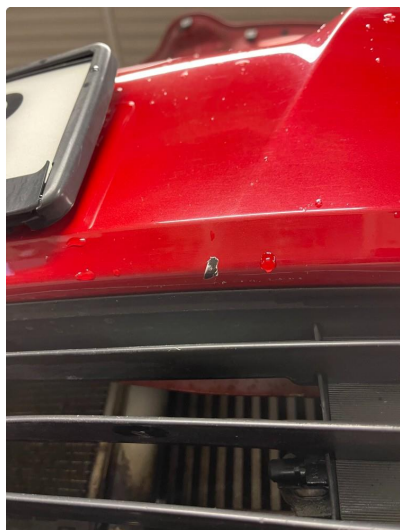
1.1 Noen små bulker med lakkskader
