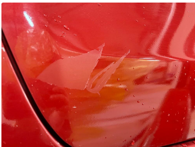
1.1 Noen små bulker med lakkskader
