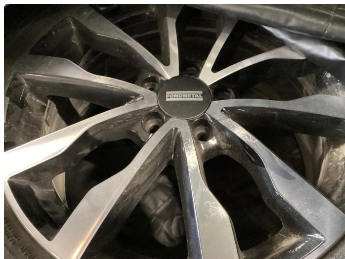
1.1 Vinterfelger har noen merker med oksidering i lakk.
