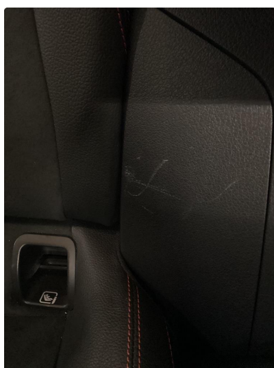
3.1 Deksel ved sete vsb der belte treffer har noen merker i plastikk etter at beltelås har støtt i det.
