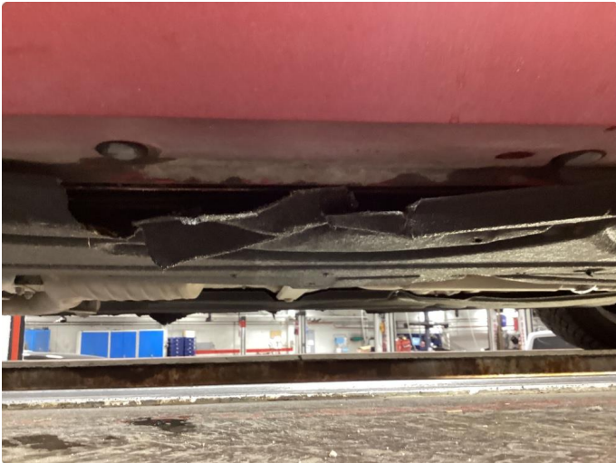
1.1 Beskyttelsesplater under bilen begge sider har små skader.
