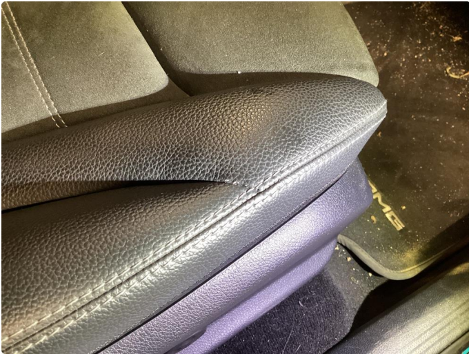
3.1 Liten slitasjeskade på trekk til sittepute hsf
