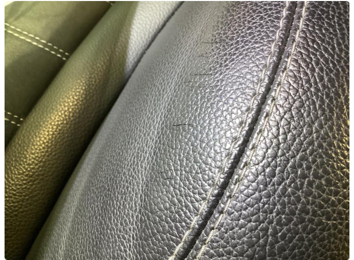
3.2 Slitasjeskade på trekk til rygg på fører sete.
