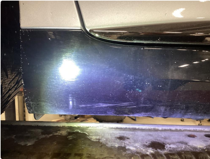
1.2 Riper i fanger bak og kanalskjørt høyre side.
