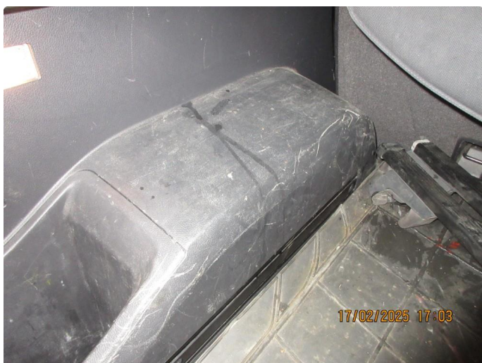
3.1 Noen riper og slitasje på deksler i bagasjerom, ett deksel er det sprekk i.
