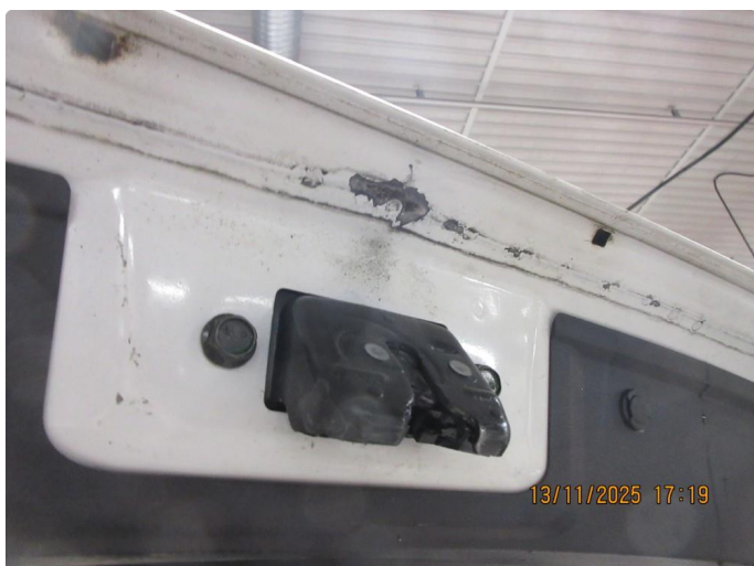
1.1 Noe lakk flass på innsiden av bakluke.
