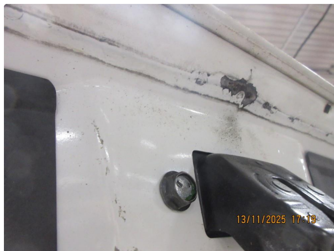
1.1 Noe lakk flass på innsiden av bakluke.
