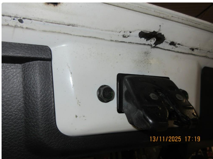
1.1 Noe lakk flass på innsiden av bakluke.
