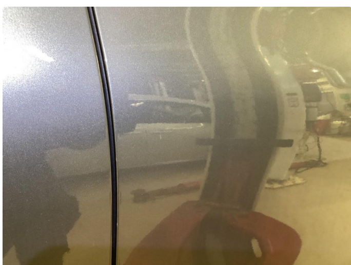
1.3 Liten ripe og bulk på høyre fordør.
