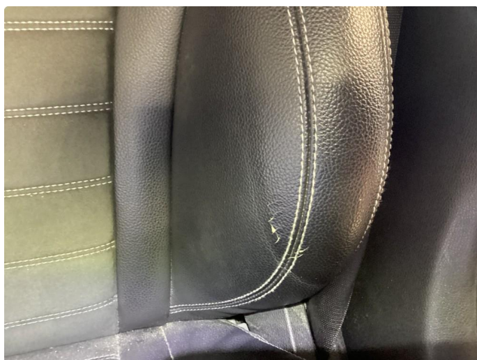
2.4 Noe sprekker i setetrekk venstre foran.
