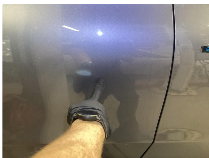
1.3 Liten ripe og bulk på høyre fordør.
