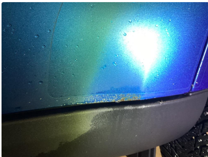
1.3 Korrosjon nede i bakkant på begge bakdører.
