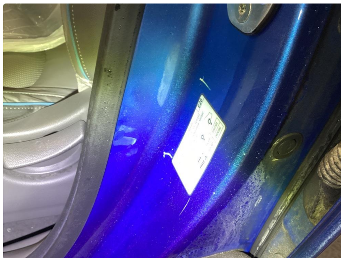
1.6 Noen riper og småbulker i innsteg vsb og vsf
