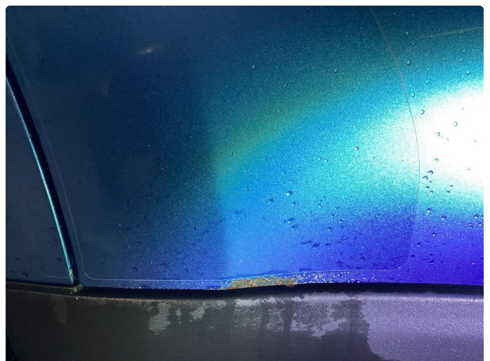
1.3 Korrosjon nede i bakkant på begge bakdører.
