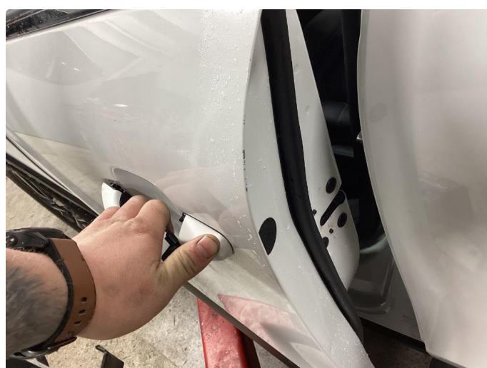
1.2 Liten lakkskade i dørkant førerdør rett bak dørhåndtak.
