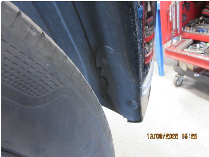
1.1 Liten sprekk i forkant av lokariskjerm høyre side foran.
