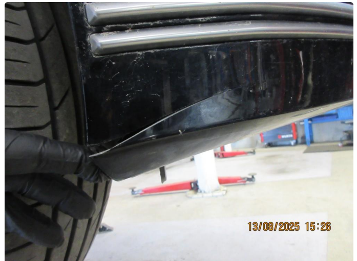
1.2 Liten skade på høyre nedre hjørnet av frontfangeren. sprekk i plasten på nedre del.
