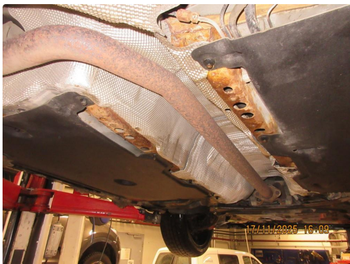
2.1 Noe overflaterust under bilen, på travers og karroseri. Ikke gjennomgående.
