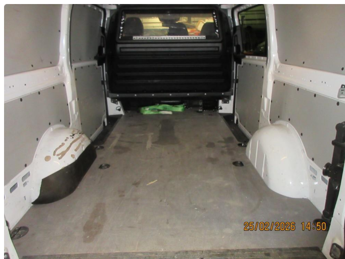
2.1 Diverse riper og slitasje i varerom
