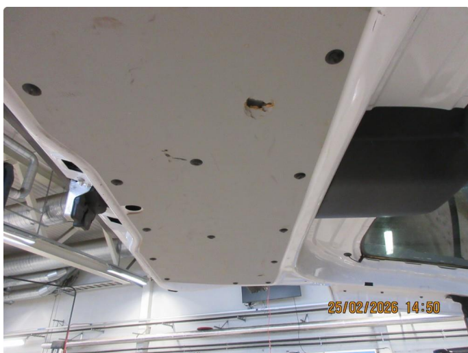
2.1 Diverse riper og slitasje i varerom
