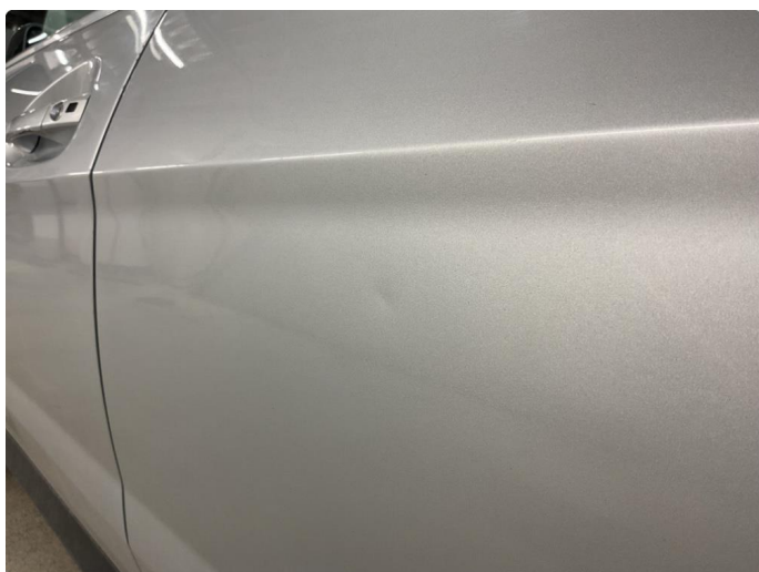
1.1 Noe riper og småbulker
