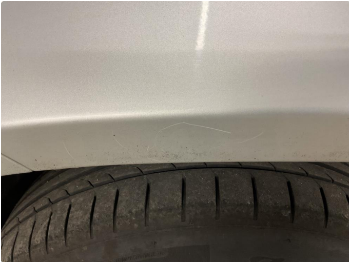
1.1 Noe riper og småbulker
