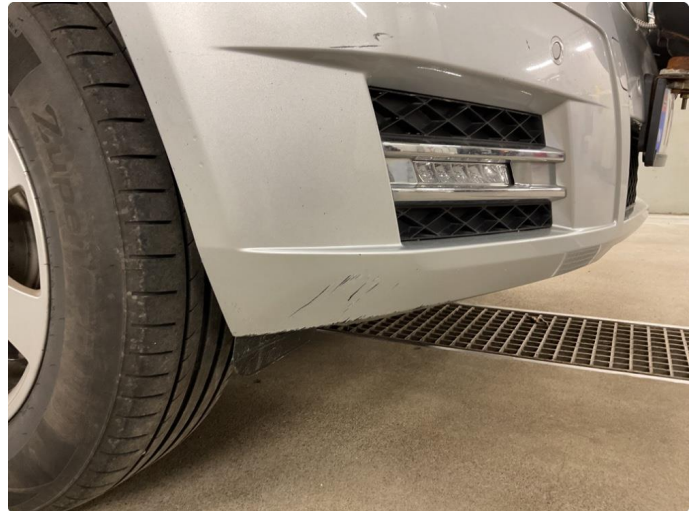
1.1 Noe riper og småbulker
