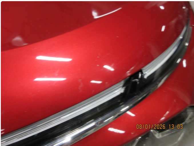
1.1 Noe steinsrput merker på panser. ingen rust.
