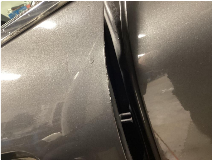
1.2 Liten lakkskade i dørkant rett bak dørhåndtak .
