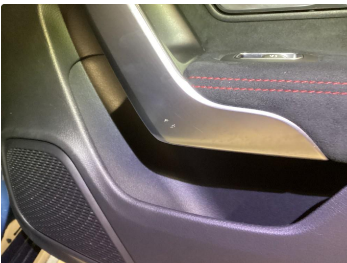
2.2 Skadet/merker etter utstyr
