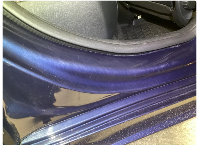
1.1 Noe slitt innsteg i døråpning begge bak + høyre foran.
