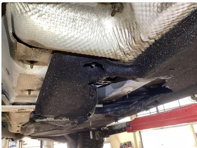
2.2 Beskyttelsesplate under noe skadet.
