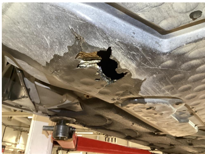
2.2 Beskyttelsesplate under noe skadet.
