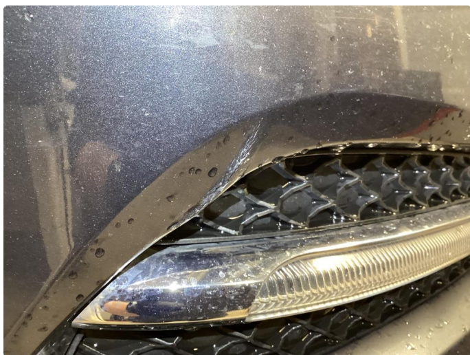
2.4 Liten skade på støtfanger hsf
