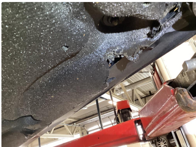
2.2 Beskyttelsesplate under noe skadet.
