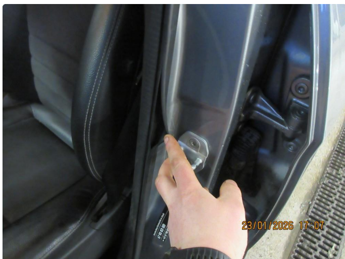
1.2 Hull i dørpaking på førerside.
