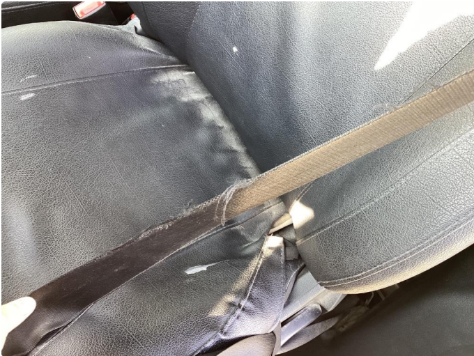
3.1 Skade på belte
