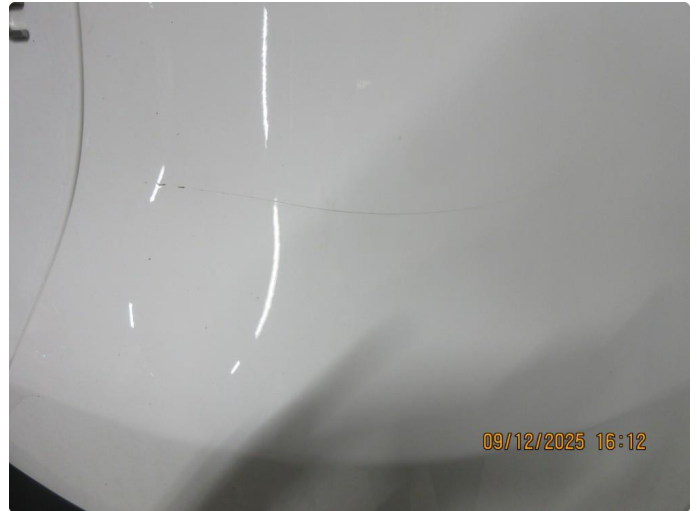
2.1 Svak ripe på høyre hjørnet av bakfanger.
