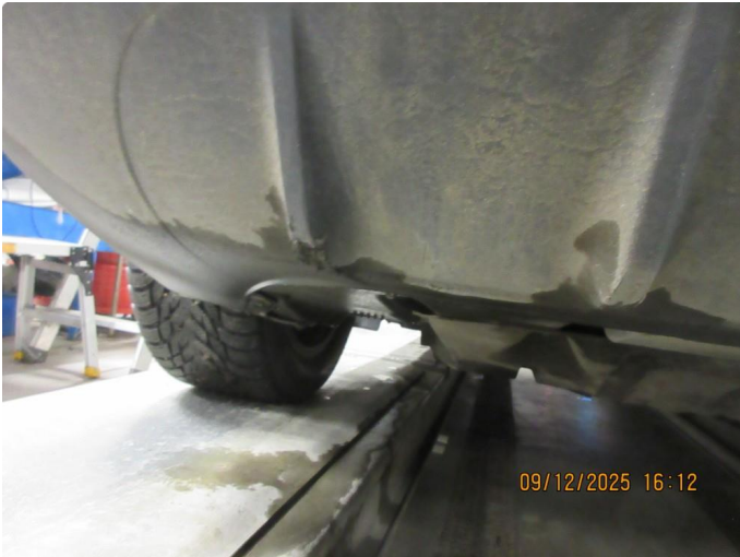
2.2 Oppskrapet difuser bak
