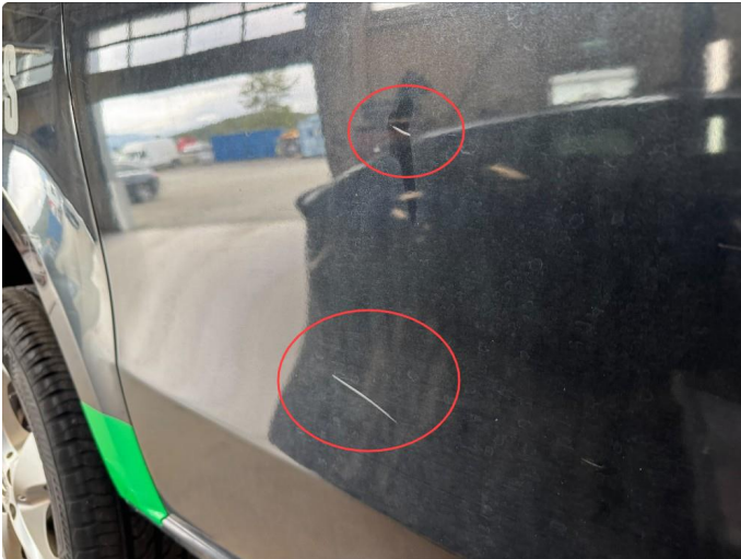
1.2 Små riper skyvedør høyre side
