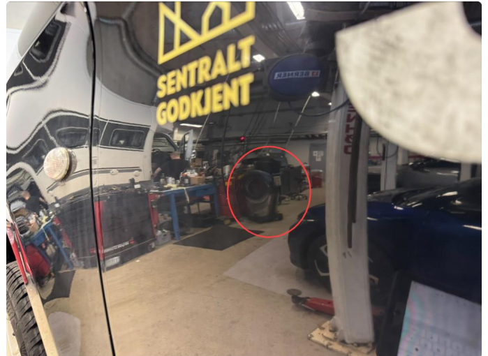
1.3 Noen bulker på førerdør.
