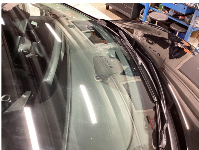
1.2 Steinsprut i frontrute.
