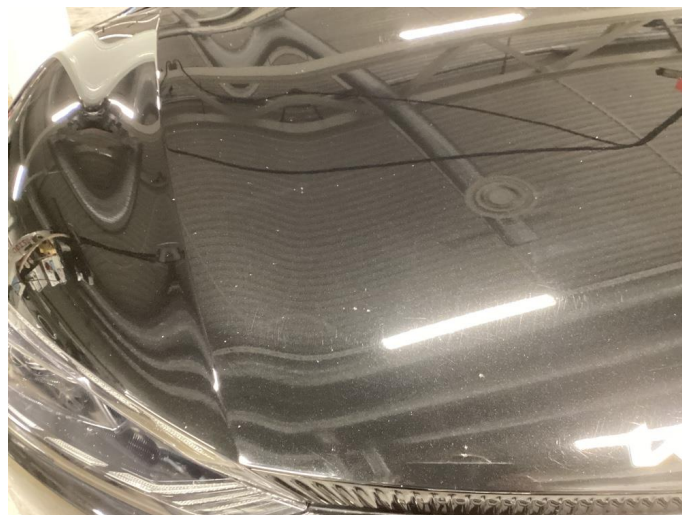
1.1 Noe riper i lakk. Skade vsf på støtfanger og lakk flasser. Riper under på støtfanger foran hs.
