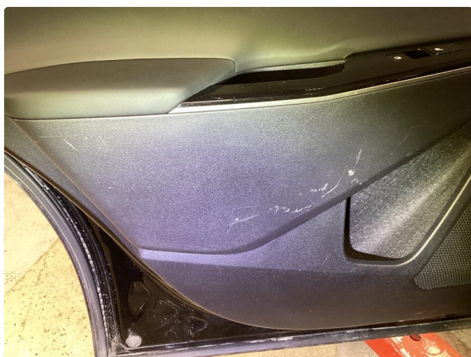
2.1 Dørtrekk på dør vsb har riper. Merker i dørtrekk samt list ved vindus bryter er riper i.
