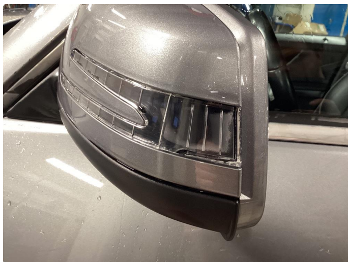
2.1 Smått krakkelert i plast i begge blinklys i speil.
