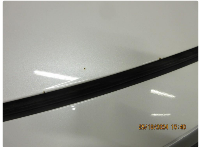
1.1 Noen steinsprang merker på panser
