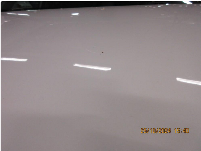
1.1 Noen steinsprang merker på panser
